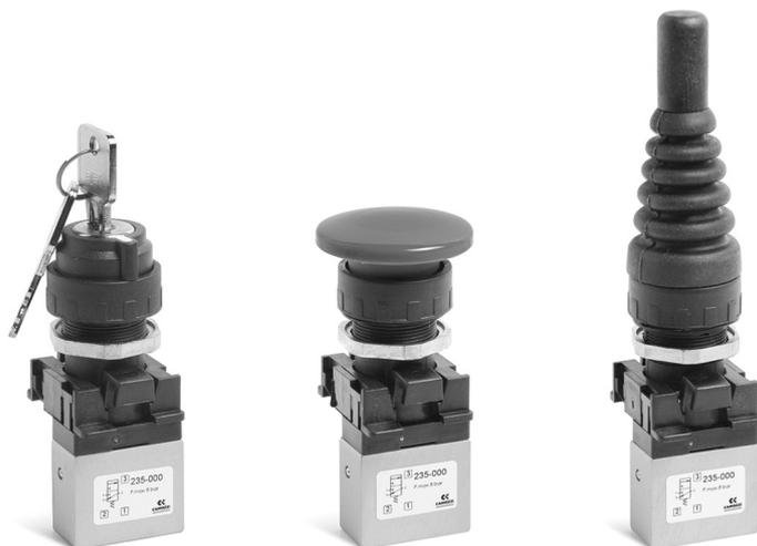
Минираспределители с ручным управлением панельного монтажа Серии 2 имеют присоединительную поверхность  $\varnothing$  22 мм и состоят из распределителя и переключающего механизма. Тип переключающего механизма – кнопка, тумблер, джойстик и замок. Для монтажа минираспределителей в отверстия  $\varnothing$  30 мм необходимо использовать адаптер Мод. 200-2230.
