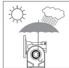
При установке устройства вне помещения, обеспечьте защиту от атмосферных осадков.
