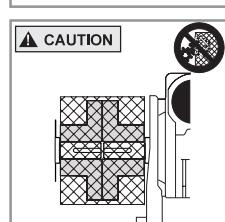
Пользователь обязан защитить вал и любые приводные механизмы, установленные на нем, с помощью предохранительного кожуха. Также пользователь должен следовать местным правилам по технике безопасности. Неправильная эксплуатация устройства может привести к серьезным травмам и/или повреждению оборудования.
