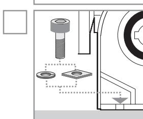
Производите монтаж редуктора на ровную поверхность, не подверженную вибрации. При высокой внешней радиальной нагрузке необходимо усилить опорную поверхность головки болта с помощью шайбы (см. рисунок)
