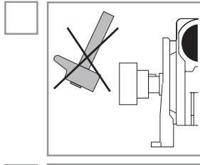
При установке шестерен, муфт или шкивов на валах редуктора следует избегать толчков и ударов, используя соответствующие съемники, которые крепятся с помощью резьбовых отверстий на торцах валов.
