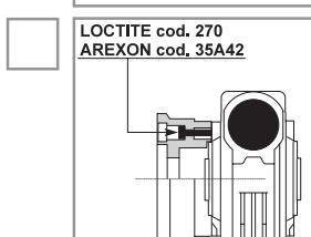
Если устройство эксплуатируется с частыми пусками, остановками и реверсированием хода, в качестве крепежных элементов следует использовать болты Loctite код 270 или подобные.
