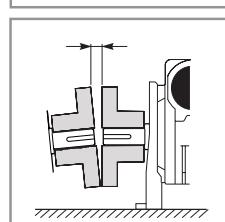
Убедитесь, что валы и муфты укреплены правильно. Проверьте плотность соединений, а затем зафиксируйте крепежные болты. Периодически проверяйте плотность крепления.
