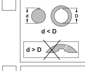
При монтаже элементов на вал редуктора необходимо использовать противозадирный и противоокислительный составы.
