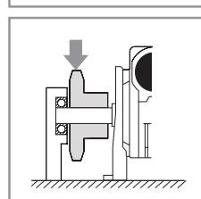
Для предотвращения преждевременного износа подшипника и поломки вала при большой радиальной нагрузке требуется дополнительная опора.
