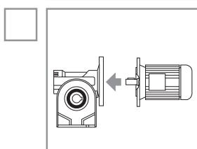
При монтаже двигателя на редуктор, крепежные болты следует затягивать при соприкосновении поверхности двигателя с фланцем редуктора. После завершения убедитесь в правильности монтажа, повернув крыльчатку.
