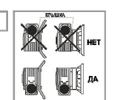
При высоких нагрузках не следует фиксировать редуктор с помощью боковой крышки. Для фиксации лучше использовать противоположную сторону. Редуктор следует напрямую зафиксировать на корпусе.
