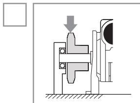
Для предотвращения преждевременного износа подшипника и поломки вала при большой радиальной нагрузке требуется дополнительная опора.
