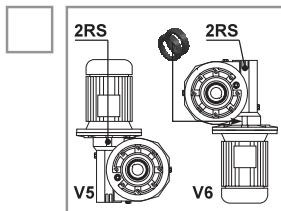
Не изменяйте монтажную позицию без разрешения производителя. Для изменения монтажной позиции может потребоваться определенный тип смазки. Если редукторы, установленные в монтажные позиции V5 или V6, эксплуатируются в непривывном режиме, необходимо заменить верхний подшипник на самосмазывающийся подшипник. Для монтажной позиции типа V6 рекомендуется использовать входное двустороннее маслостойкое уплотнение.
