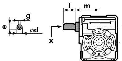
**PQ75.....S...** Односторонний выходной вал
