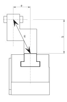
При условии, что центр масс захватываемого объекта часто смещен вверх на высоту губок (b) и иногда смещен вбок относительно оси движения губок (e), результирующий рычаг R по отношению к плечу (b) и эксцентриситету (e) может быть рассчитан по формуле:
