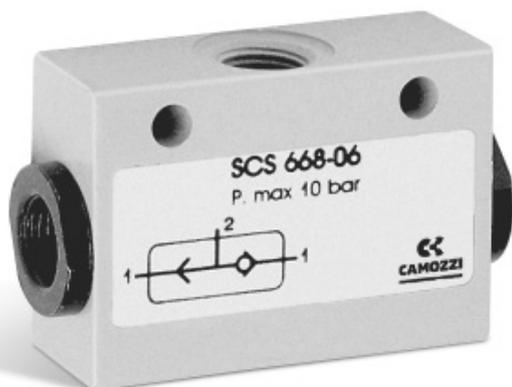
Перекидной клапан Мод. SCS-668-06 выполняет логическую функцию "ИЛИ" и предназначен для подачи на выход любого из двух сигналов, поступающих на входы. Специальная конструкция обеспечивает надежное уплотнение между входными отверстиями для исключения ложных срабатываний и утечек воздуха.
