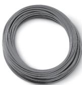
Трубопровод PV из поливинилхлорида в оплётке предназначен для подачи воздуха в пневматических системах под высоким давлением. Обладает хорошей стойкостью к истираниям, перегибам. Монтируется только с использованием фитингов с накидной гайкой (Серия 1000).
