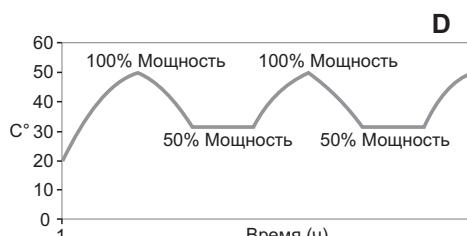
Мотор-редукторы с входной скоростью  $2800 \text{ min}^{-1}$  должны использоваться только для кратковременного режима работы из-за высоких температур, вызванных входной скоростью.
